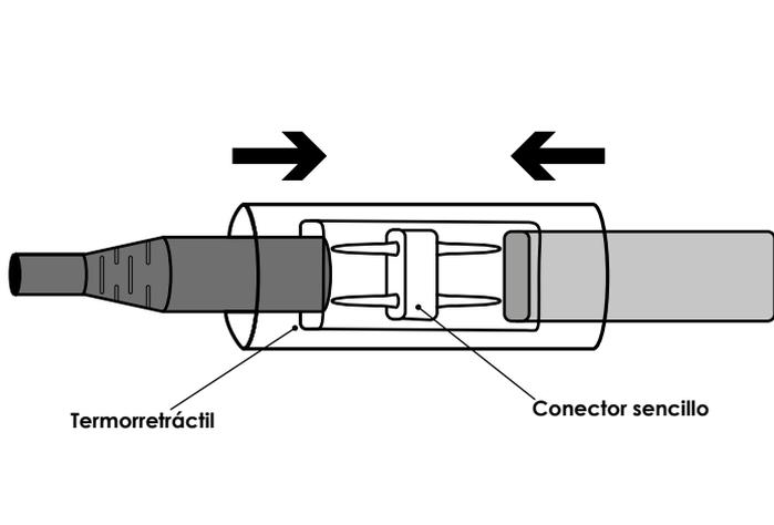
4. Inserte el otro FLEXILIGHT LED MINI NEON en el conector. Asegúrese que el conector ha quedado fijado en la posición correcta dentro del FLEXILIGHT LED MINI NEON.
