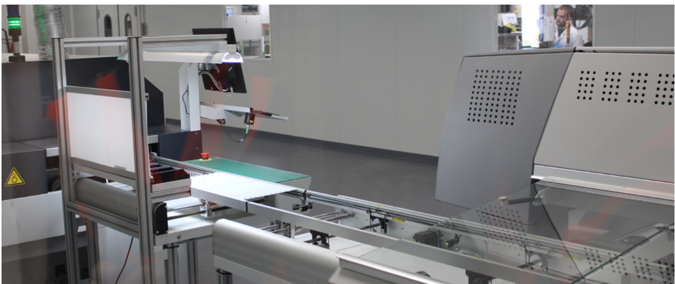
Línea de montaje Pick&Place de placas SMD para chip LED.
